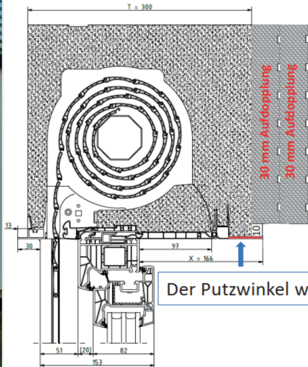
Variante B: 10 mm versetzt zum Putzwinkel
